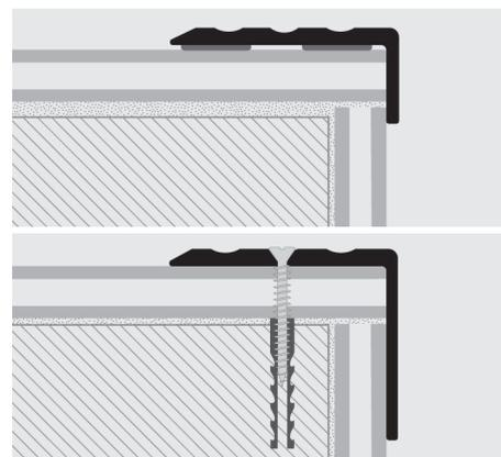
**PROSTEP INS** è un profilo parapradino in alluminio anodizzato argento ideale per proteggere e posare gradini in legno laminato / melaminico flottanti e parquet. Disponibile in due altezze H. 10,2 e 15,9.
