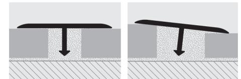
1. Scegliere il "PROCOVER" nella larghezza corrispondente alla fuga fra i due pavimenti da collegare considerando un appoggio laterale di 2/3 mm. 2. Riempire la fuga con proband fix monocomponente o con il collante usato per la posa del pavimento. 3. Affondare il profilo nella colla facendo attenzione che appoggi con entrambi i lati sui rivestimenti da collegare.
