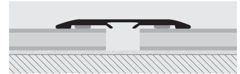
1. Scegliere il SOL 40 adesivo della finitura desiderata. 2. Tagliare il profilo alla lunghezza richiesta e pulire, sgrassare e asciugare il piano verificando che la temperatura di applicazione non sia inferiore a 15°. 3. Rimuovere la carta protettiva dell'adesivo e posare il profilo correttamente con una pressione verticale manuale uniforme senza muovere il profilo e senza l'utilizzo di martelli in ferro/acciaio.
