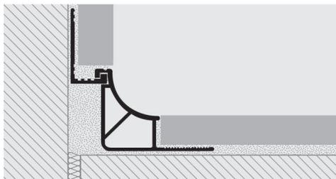
1. Scegliere "PROGUSCIO DA" in funzione del colore e dell'altezza desiderata. 2. Tagliare "PROGUSCIO DA" alla lunghezza desiderata ed applicare il collante sul supporto dove sarà posato il profilo. 3. Premere l'aletta di ancoraggio di "PROGUSCIO DA" nel collante. 4. Posare il pavimento ed il rivestimento avendo cura di allinearla con l'altezza del profilo e di lasciare una fuga di circa 2 millimetri. 5. Stuccare accuratamente le fughe tra profilo e piastrella onde evitare il ristagno di acqua.
