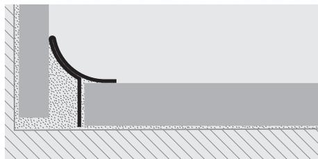
1. Je nach Oberflächendekor "PROINTER KL ACC" auswählen. 2. Das zugeschnittene "PROINTER KL ACC" zur gewünschten Länge schneiden. 3. Das Silikon zwischen Wand und Boden auftragen. 4. Die Spitze im Form von Pfeil von "PROINTER KL ACC" im Silikon drücken, sodass es zum Wand und Boden haftet.
