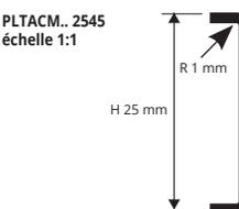
ACIER INOX AISI 316LL/1.4404-V4A POLI avec film de protection - longueur b. 2,7 ML cond. 40 Pces - 108 ML - 8/10mm
