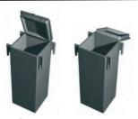
préfabriqués. Il doit être placé dans le panneau ou dans la poutre dès que le bétonnage a été effectué. Avant le montage, il est nécessaire d'ouvrir les couvercles pour introduire le poteau. Une fois le travail terminé, fermer et imperméabiliser les trous pour éviter les infiltrations d'eau et donc l'humidité.
