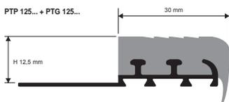
PROSTEP est un profilé technique, utilisé pour rendre les marches antidérapantes, qui permet de protéger les marches des escaliers en céramique et de prévenir les accidents. Il est composé d'une base rigide en résine vinylique très résistante et d'un insert interchangeable strié, en caoutchouc vinyle, disponible dans des différentes couleurs et hauteurs. Conformément aux normes CEE, il est obligatoire dans les lieux publics pour prévenir les accidents.
